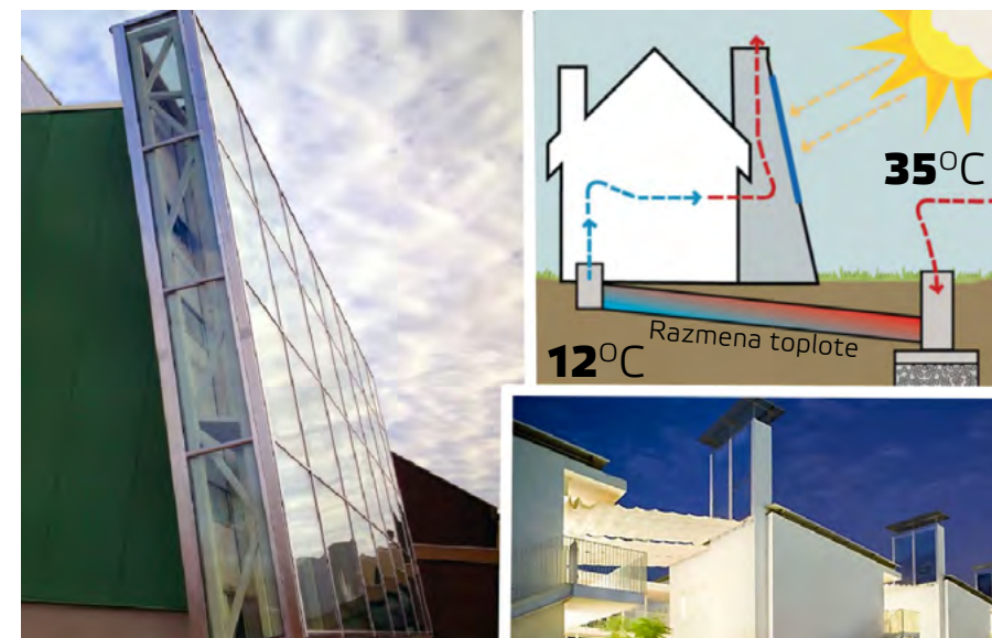
Kako funkcioniše solarni dimnjak
